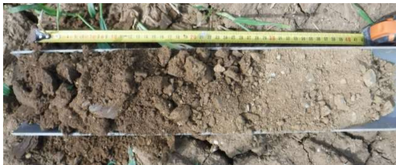
Figure 28 : Sol avec un horizon de labour (0-29 cm) et un horizon éluvial (29-42 cm) sans aucune trace d'hydromorphie visible, (Point n°12)
